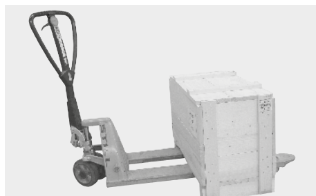
Transport emballé dans la caisse de transport ou sur une palette avec des moyens de levage appropriés (p. ex. chariot de levage).
