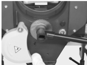
Fixation de la lame de scie/fraise
