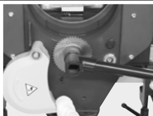
切割刀片 / 坡口刀片固定装置
