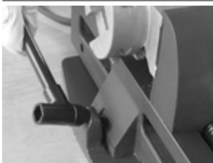
将GF 4/GF 6固定到快速安装板上
