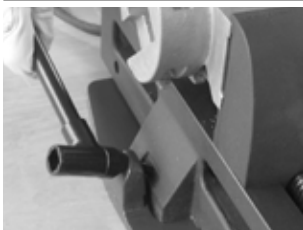
Upevnenie stroja na montážnu platňu
