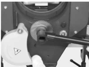
Крепеж отрезной фрезы
