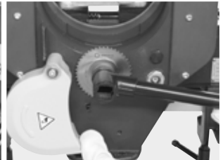
Upevnění pilového kotouče/frézy
