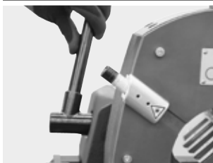
Fijación para mordazas (solo para el modelo GF 4 (AVM/MVM))
