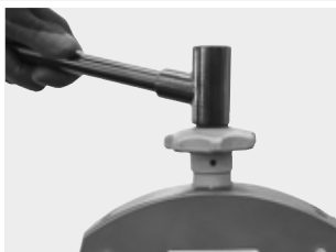
Регулировка диаметра труб
