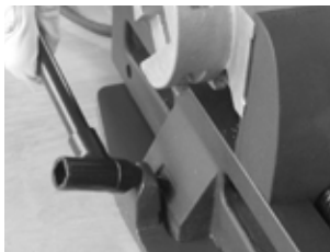
Upevnění pily na trubky na rychloupínací desce
