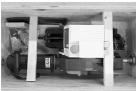
运输箱中的 GF 6(自动/手动进刀模块) · 带框架
