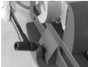
Befestigung der Säge auf der Schnellmontageplatte
