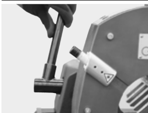
固定夹固定装置 (仅对于 GF 4 (自动/手动))
