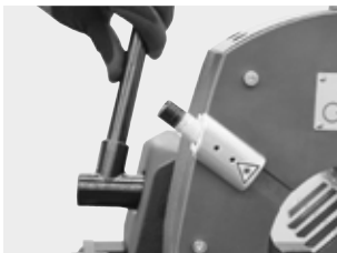
Uchytávacie čeluste-upevnenie (iba pri GF 4 (AVM/MVM))
