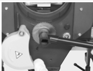
Fissaggio della lama/fresa
