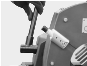
Spannbacken-Befestigung (nur bei der GF 4 (AVM/MVM))
