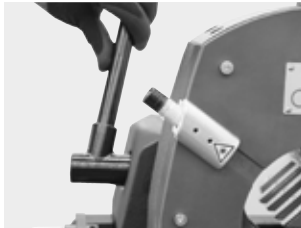
Fissaggio delle ganasce (solo per GF 4 (AVM/MVM))
