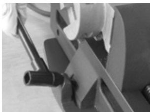
Закрепление трубореза на плате быстрого монтажа
