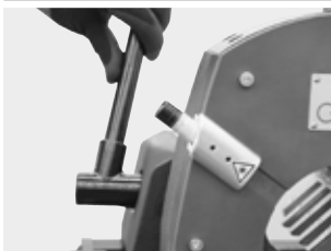
Upevnění čelistí svěráku (jen u GF 4 (AVM/MVM))
