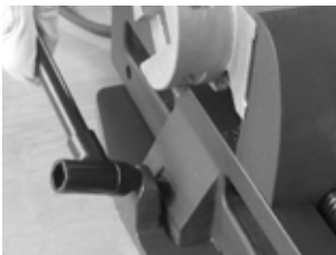
Fixation de la machine sur la plaque de montage rapide
