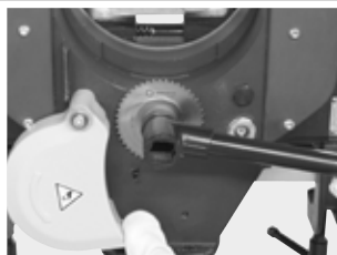
Upevnění pilového kotouče/frézy
