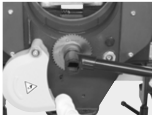
Fixation de la lame de scie/fraise
